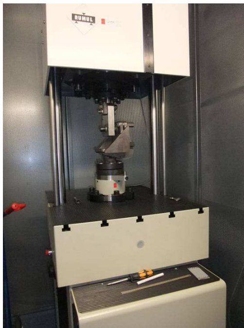
Bild 1: Hochfrequenz-Resonanzprüfmaschine, verwendete Versuchseinrichtung für Dauerschwingversuche
